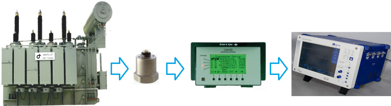
شکل ۳: شمای کلی سیستم آزمون عملی شامل ترانسفورماتور قدرت، سنسور شتاب‌سنج، تقویت کننده و اسیلوسکوپ.
