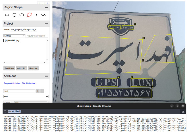
شکل ۳: نمونه‌ای از حاشیه‌گذاری یک تصویر با استفاده از نرم‌افزار متن باز VIA [۶۷]. ردیف بالا کادرهای محصورکننده چهار ضلعی کلمات و ردیف پایین داده‌های حاصل از حاشیه‌نویسی این تصاویر را نشان می‌دهد.
