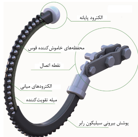
شکل ۱: بخش‌های مختلف ساختار برق گیر چندمحفظه‌ای مدل i۲۰Z.
