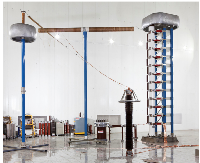
شکل ۸: مجموعه مولد ۱۲۰۰ کیلوولت ۱۲۰ کیلوژول جریان ضربه صاعقه ساخته‌شده.
