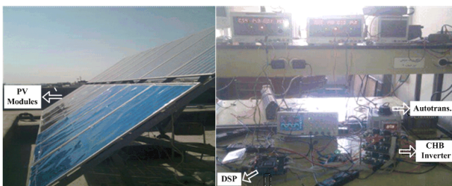
شکل ۹: تصویر مجموعه آزمایشگاهی برای تست اینورتر \gamma سطحی پل متوالی.
